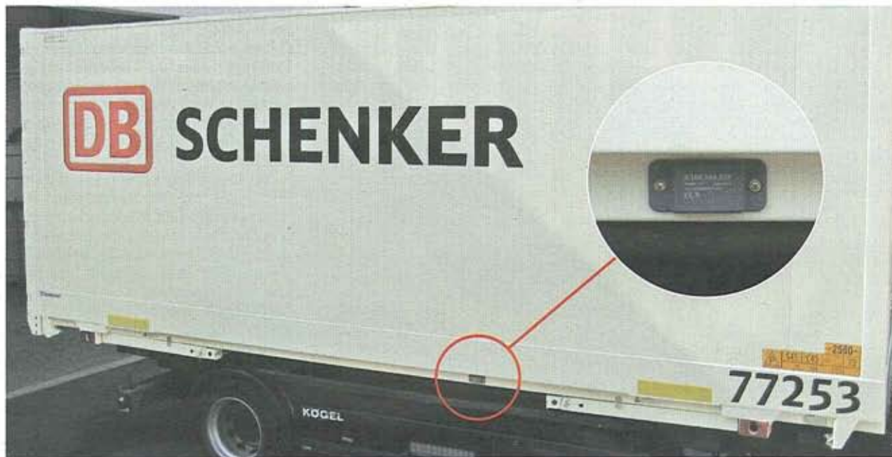
Der RFID-Transponder ist in gut einer geschützten Nische an der Wechselbrücke befestigt.
